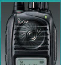
El amplificador de serie tipo BTL, dobla la potencia y el altavoz de grandes dimensiones de 40mm suministran un audio potente (800mW típ.)
